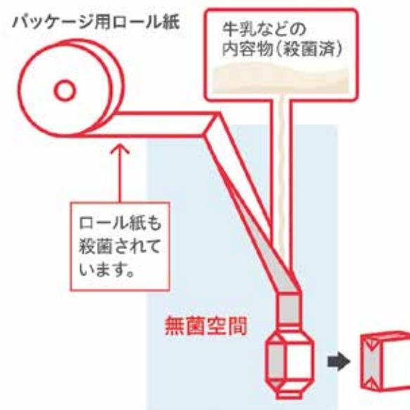
食品が腐る原因は、主に細菌やカビ、酵母など目に見えない小さな生き物（微生物）による。食品を常温で長期保存すると、普通なら微生物が繁殖し、腐ってしまう。腐るのを防ぐためには殺菌の上、無菌の状態を維持する必要がある。そこで、「どうすれば菌が増えない期間を長くする事ができるだろう？」と考え、「無菌の空間を作り出し、その中で殺菌した容器に殺菌した内容物を充填して密封する」という方法を生み出した。
